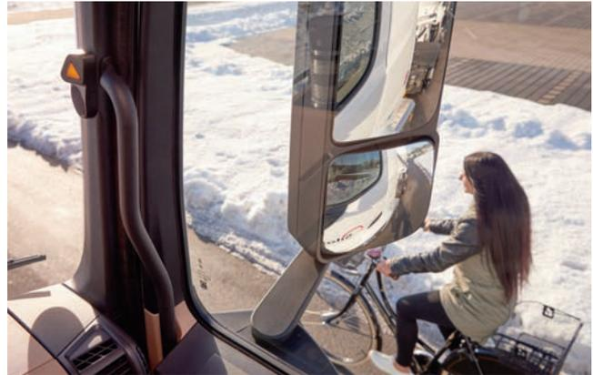
Besteht unmittelbare Kollisionsgefahr, alarmiert der Assistent den Fahrer.
