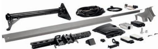
Einbaukomponenten für die Nachrüstung des Abbiege-Assistenten S1R z. B. für Eonic
